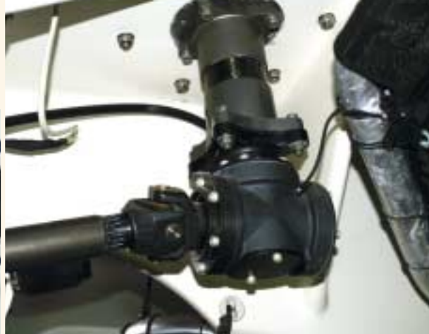
Kardáncsuklós rendszerrel működik a csörlő meghajtása (balra)
